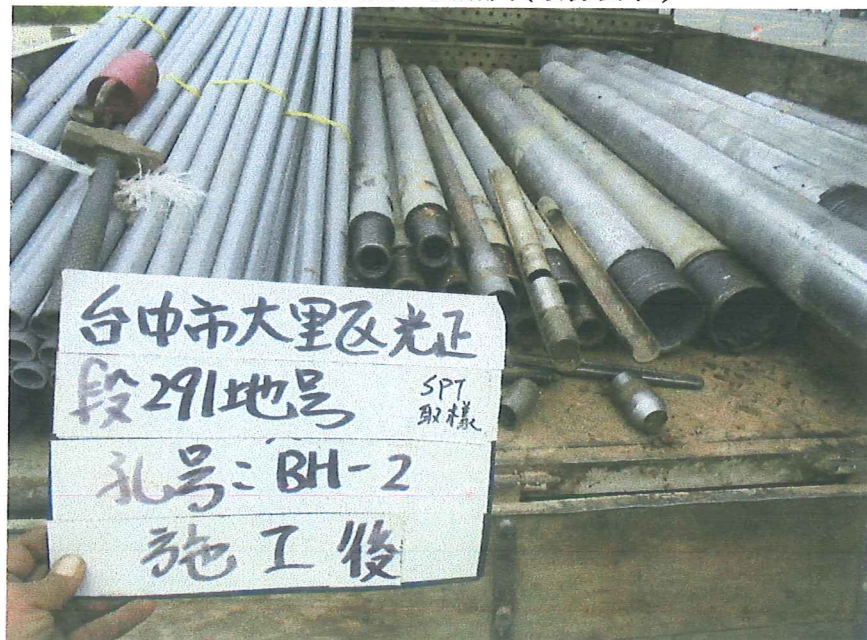
BH-2 孔 施工後照片(取樣劈管)
