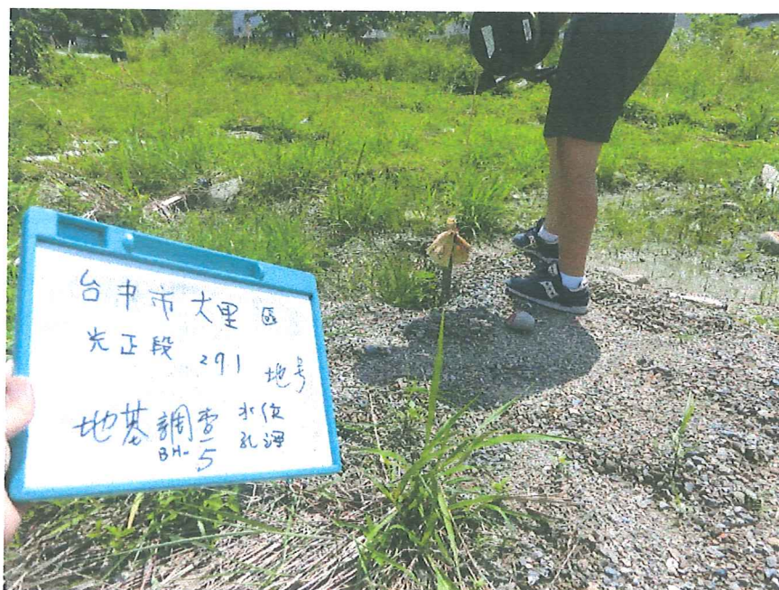
BH-5 孔地下水位觀測井照片
