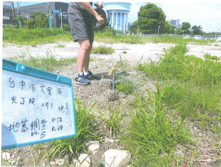
BH-5 孔 地下水位觀測井照片
