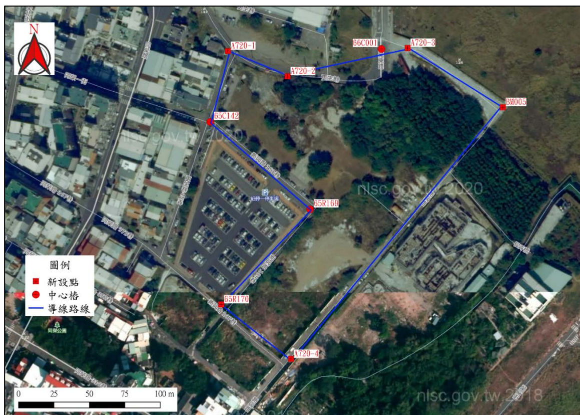
圖 3-1、導線測量路線圖
