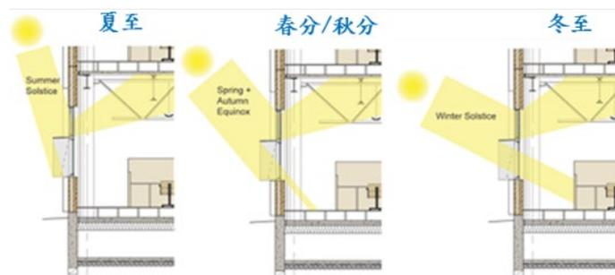
圖 8.2-1 被動式照明示意圖
