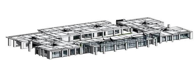
結構柱直接全棟延伸,且結構主體梁柱版關係分開
