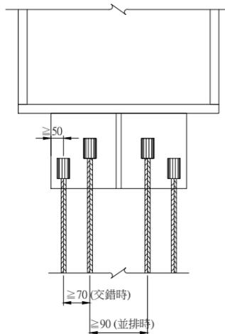
鋼筋續接器配置間距示意圖
