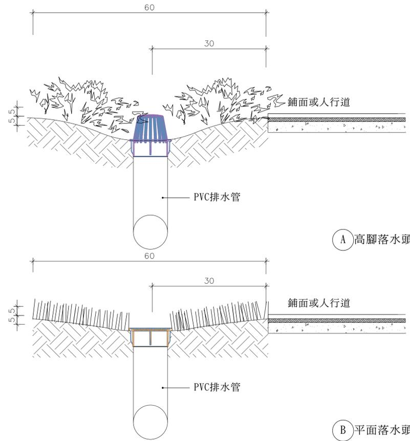
A 高腳落水頭施工示意圖
