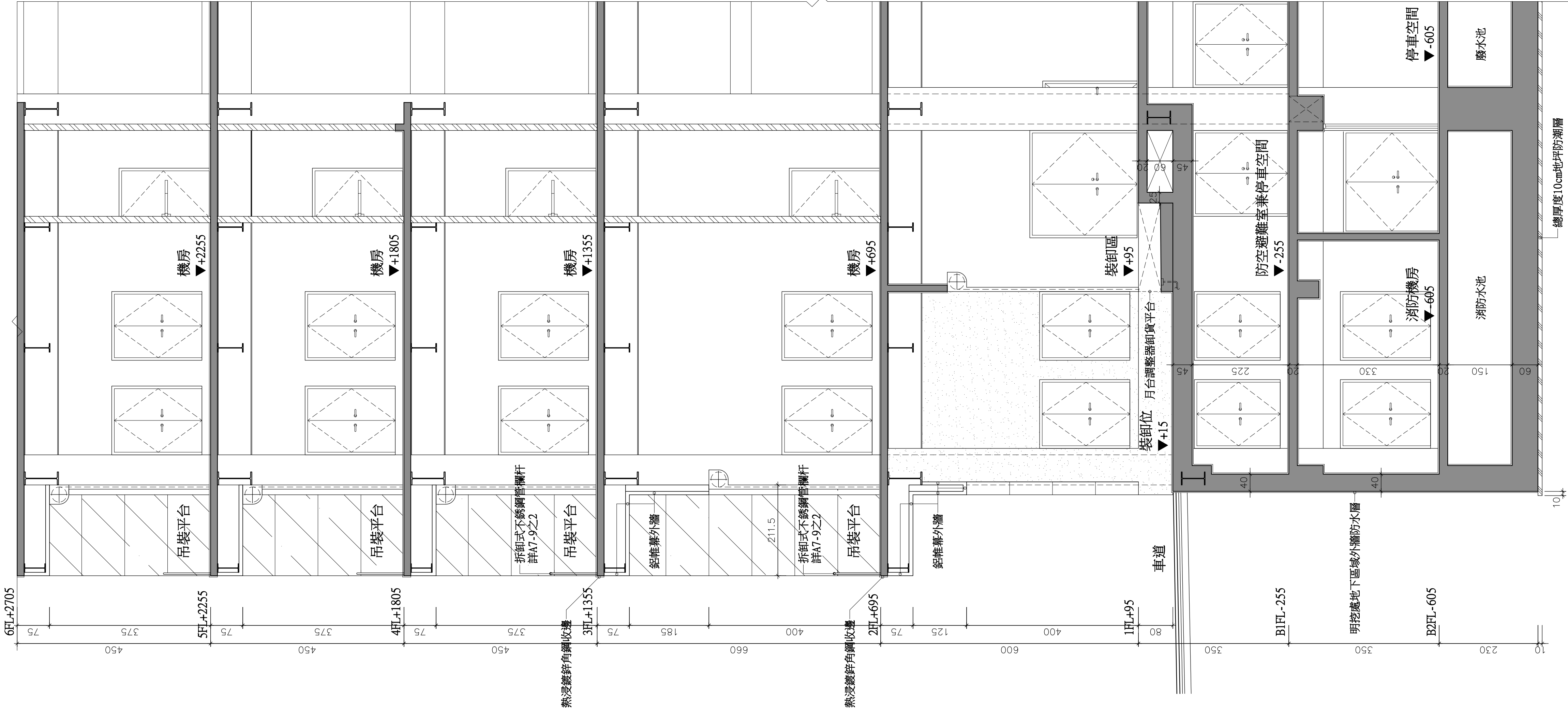
1/44-10 裝卸區外牆剖面圖(一) A1=S:1/60 A3=S:1/120
