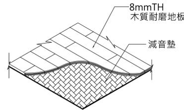
浮動式木質耐磨地板施工等角示意圖
