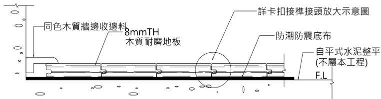
浮動式木質耐磨地板施工圖
