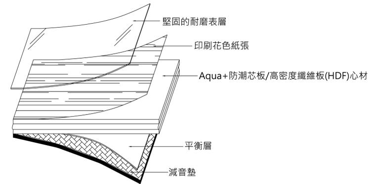
浮動式木質耐磨地板構造示意圖
