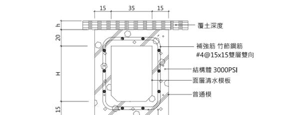
1 TYPE-A 排水暗溝詳圖 (W=35)
