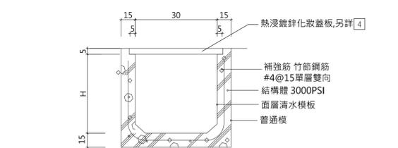
2 TYPE-B 排水溝 (W=30) + 熱浸鍍鋅化妝蓋板
