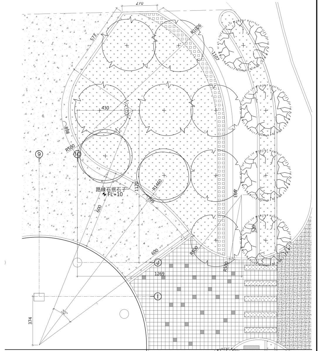
2 高壓混凝土磚鋪面平面圖(二) A1 S:1/80
