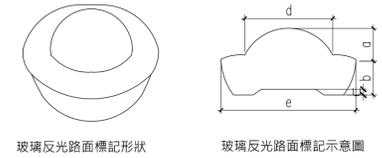
強化玻璃反光路面標記(1F~B3F車道斜板兩側)
