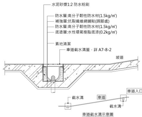
5 車道載水溝防水層施工詳圖 防水材料施工規範詳A7-8-1
