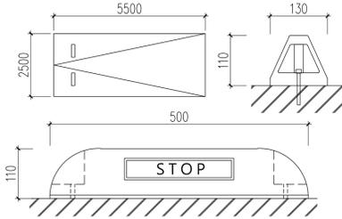
說明: 一.產品名稱: ST-531型 聚氨酯PU車輪檔 二.規格: 外觀整體尺寸550\*130\*110mm 外觀厚度8mm內構造厚度6mm 三.材料: 輪檔材質:合成纖維塑料經射出模灌一體成型耐撞. 洩水口:每支輪檔須有二處以上洩水口,以防止積水 受壓強度:3000-3800磅/英寸 衝擊力:2.0英尺-磅/吋 硬度:65shore D 吸水性:<0.1%24H(ASTM D570) 密度:0.917-0.980克/立方公分(ASTM D 7920) 四.固定方式:以5/16" X3"膨脹螺絲固定並固定於RC版上. 以上材質說明及物理特性,承包商應於送審資料上註記或提出原廠證明(同級產品亦適用此規範).
