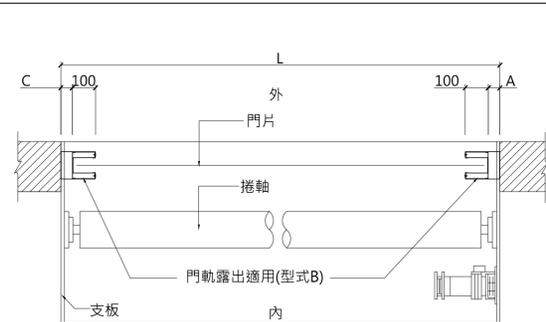
註：支板,捲軸表面粉體烤漆膜厚50µm以上,硬度H。
