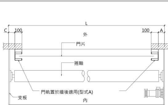
註：支板,捲軸表面粉體烤漆膜厚50µm以上,硬度H。
