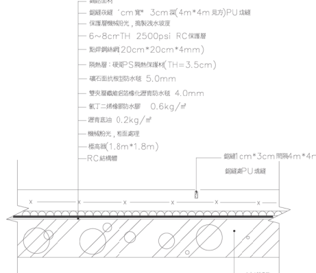
8 屋頂、屋頂版、屋突、露台、陽露台 防水隔熱隔熱工程大樣圖
