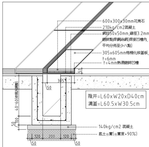
05 A型鋪面排水溝陰井+檢修口
