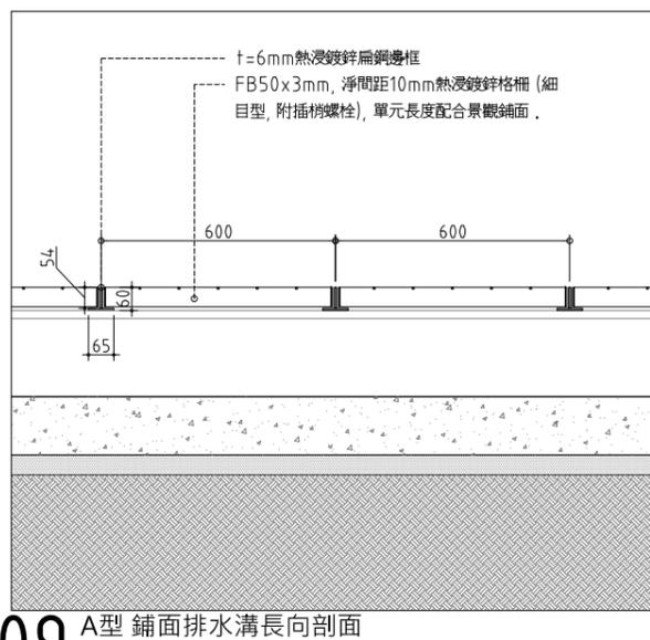
09 A型鋪面排水溝長向剖面
