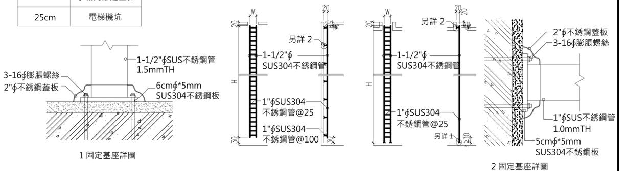
註: 1.圖示H值>3M時,於地面2M以上部份須設防護欄。
