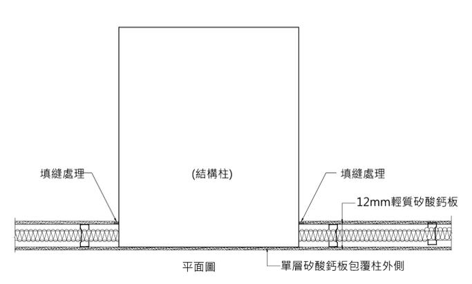
3 室內輕隔間與柱施工示意圖
