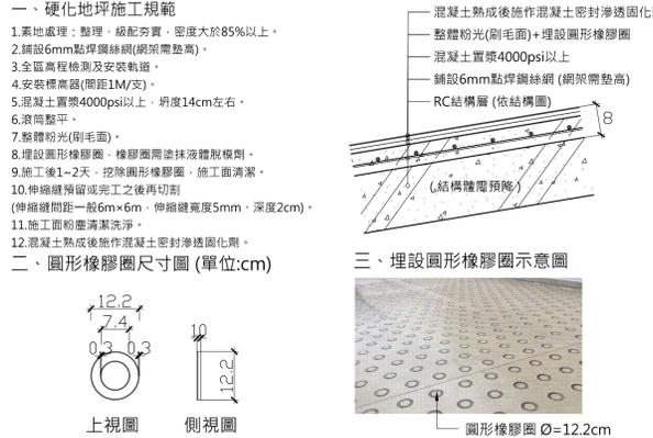
16 混凝土硬化車道地坪埋設圓形橡膠圈詳圖 (F14)
