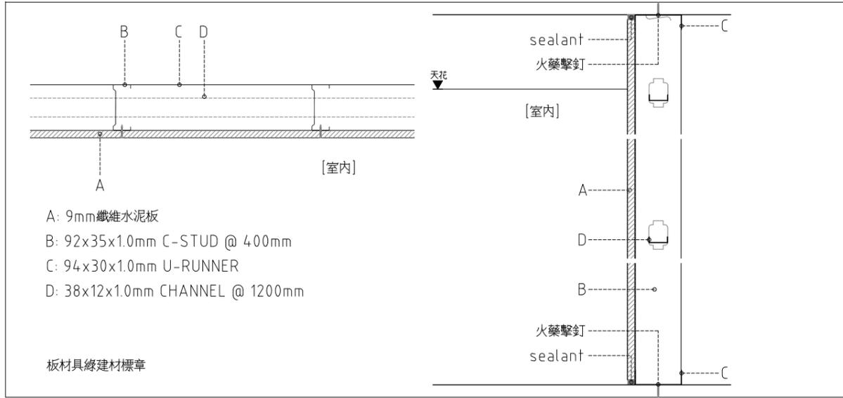
**4** TYPE C: 乾式內牆單面封板
