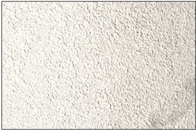
添加天然石砂砂或天然石英骨料，使表面達細緻面花崗岩般之均勻細緻紋理，如上圖
